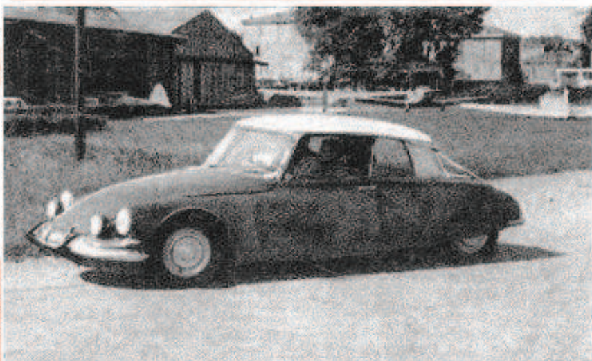
La Citroën-Maserati fotografata durante le prove sul circuito modenese. Notare il passo accorciato e l'assenza dei due sportelli posteriori
