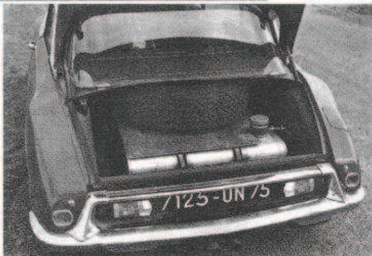
Réservoir d'essence supplémentaire dans la malle arrière qui reçoit aussi la roue de secours.
