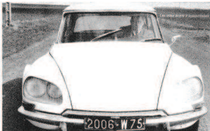
Ce coupé DS n'en est pas une. Il s'agit, en fait, de l'un des deux derniers prototypes d'essais du soubassement de la SM. Sous ce capot familier dorment six cylindres en V. On notera les ailes avant échancrées, le carénage d'ailes arrière et le ressaut de ligne après la portière, autant de signes avant-coureurs du futur coupé SM.
